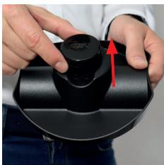
Используйте фиксирующий держатель, оттянув встроенный прижим так, чтобы закрепить нарезаемый продукт на металлических штифтах.
