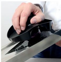
Appliquez une légère pression avec le bout du doigt sur le piston intégré du poussoir de protection pour assurer un guidage optimal et réduire les restes de coupe.
