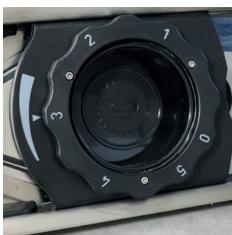
Seleccione el espesor de corte deseado mediante el botón giratorio situado en la parte inferior:
