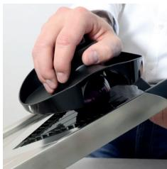
Aplique al mismo tiempo una ligera presión con la palma de la mano sobre el punzón integrado en el sujetarrestos, para así asegurar un movimiento óptimo y reducir al máximo la cantidad de restos de corte.
