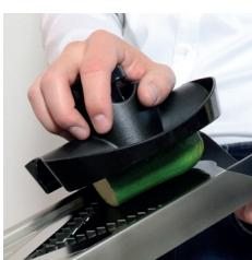
При этом слегка надавливайте пальцем на встроенный прижим, чтобы обеспечить оптимальное направление и сократить до минимума остатки при резке.
